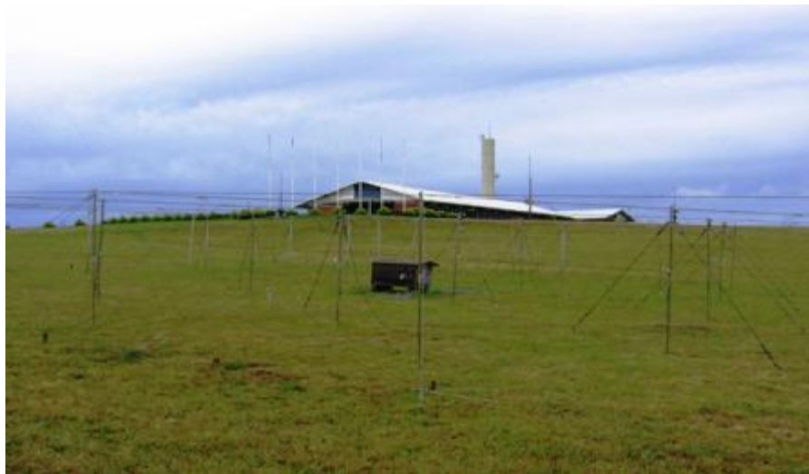
Figura 4.4 – Fotografia das antenas do riômetro imageador no Observatório Espacial do Sul, São Martinho da Serra, RS.
