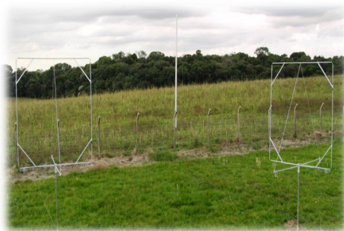
Figura 3.3 – Antenas “Loop” e antena vertical instaladas no Observatório Espacial do Sul, OES/CRS/CCR/INPE – MCTI.
